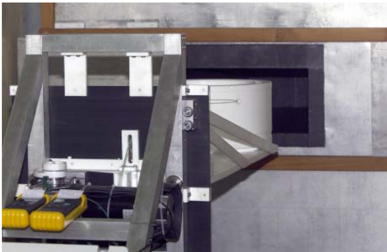
Fig. 4 Contenitore del fegato sul carrello semiautomatico all'imbocco del canale di irraggiamento nella colonna termica del reattore Triga Mark II (foto Trentani, Pavia)
