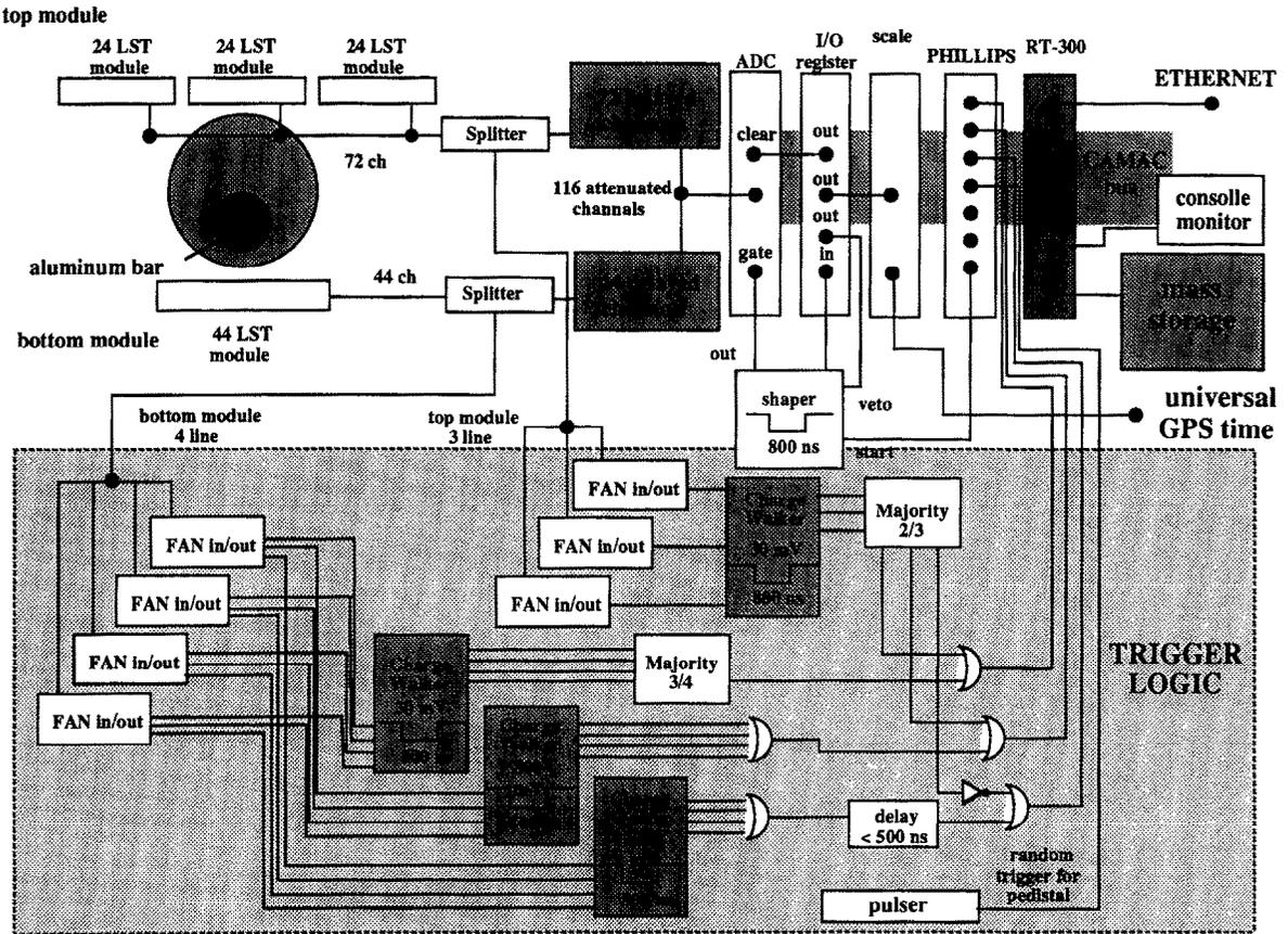
Fig. 2. Readout system.
