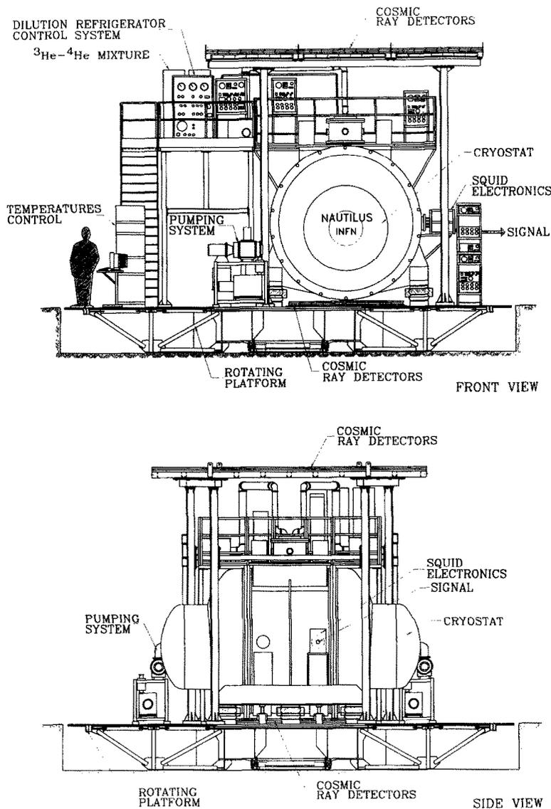
Fig. 1. Layout of the NAUTILUS antenna.
