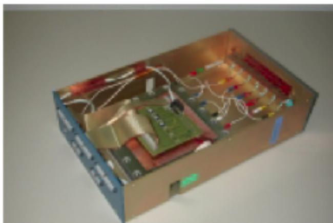
Figura 3.17: Interno del contenitore di alluminio in cui è collocata il rivelatore *tripla* GEM
