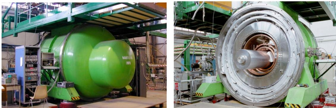
Figura 1-11: NAUTILUS: a sinistra chiuso, a destra si nota l'antenna
