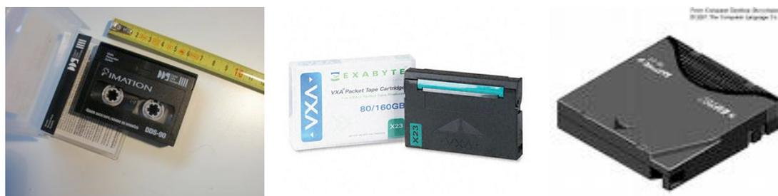
Figura 3-1: Cartridge (da sinistra): Dat, Exabyte, LTO
