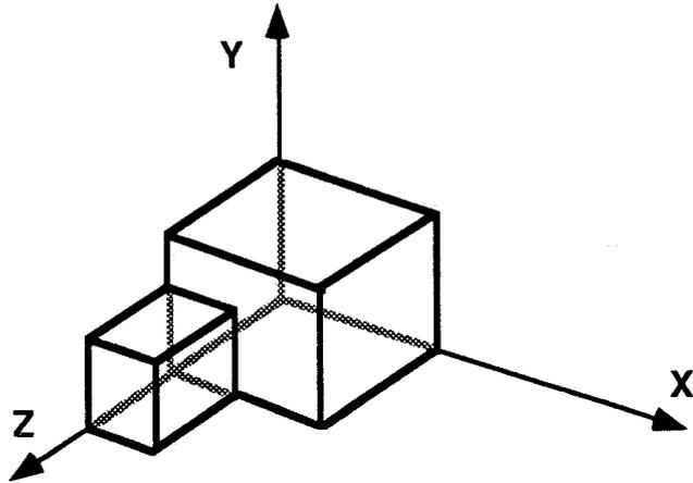
Per prima cosa costruire il blocco piu' grande. Quindi, se si opera come nel paragrafo 5, spostare la terna di assi sul punto prestabilito e ruotarla fino a quando non e' posizionata correttamente.
