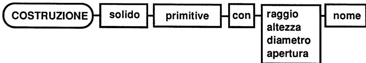
Anche per la costruzione di un solido "cono" si possono scegliere i parametri piu' opportuni (raggio o diametro, altezza od apertura). La figura mostra il significato di "apertura":
