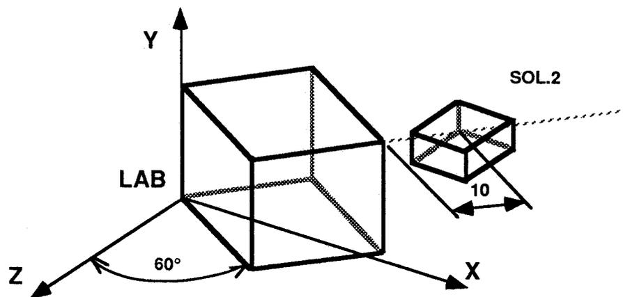
Creare il blocco "SOL.1" ruotato rispetto all'asse y di  $60^\circ$ . Per posizionare la terna di assi necessaria alla costruzione di "SOL.2" (che è simile al "LAB", ma in una posizione diversa nello spazio), entrare nel menu "posizionamento"- "pos su punto" e catturare il vertice di "SOL.1" indicato in figura: il programma propone un sistema di assi simile al "LAB".
