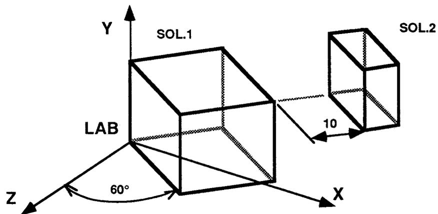
Creare il blocco "SOL.1" ruotato rispetto all'asse y di  $60^\circ$ . Per posizionare la terna di assi necessaria alla costruzione di "SOL.2" catturare la faccia indicata in figura: il programma mostra un sistema di assi che va successivamente posizionato come in figura.
