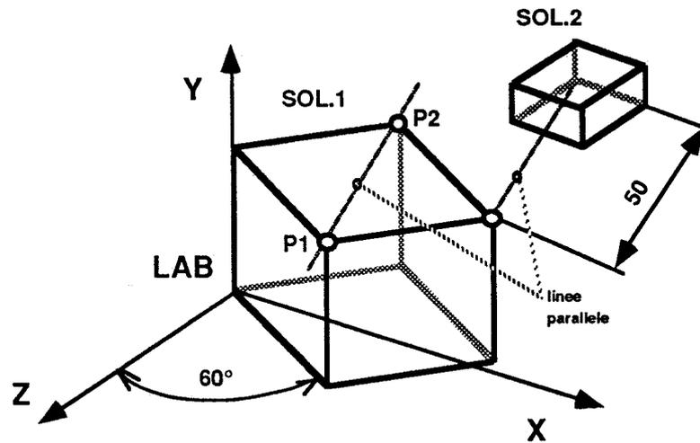
Creare "SOL.1" e, come nell'esempio precedente, posizionare "SOL.2" sul vertice del primo solido. Entrare nel menu "spostamento"-**"mosso di"**-**"traslazione"** e con M1 catturare la voce **"retta 2 punti"**, poiche' la retta lungo la quale si deve effettuare la traslazione passa per P1 e P2 di "SOL.1". Catturare P1 e P2, indicare il verso e la distanza.
