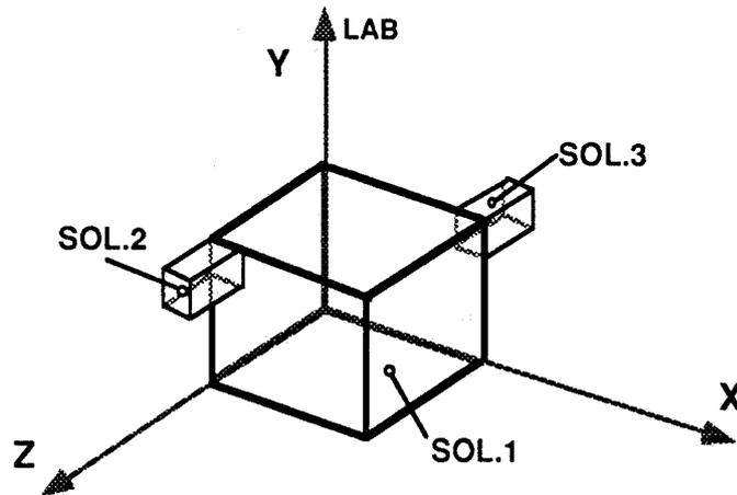
Procedere nella costruzione di "SOL.1" (di dimensioni  $x=50$ ,  $y=50$ ,  $z=50$ ). Per costruire "SOL.2" (dimensioni  $x=10$ ,  $y=10$ ,  $z=20$ ), posizionare la terna di assi come in figura.
