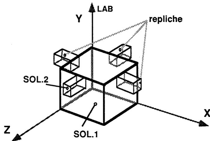
Costruire "SOL.1" di dimensioni  $x=50$ ,  $y=50$ ,  $z=50$  e posizionare il sistema di riferimento per la creazione di "SOL.2" come in figura.
