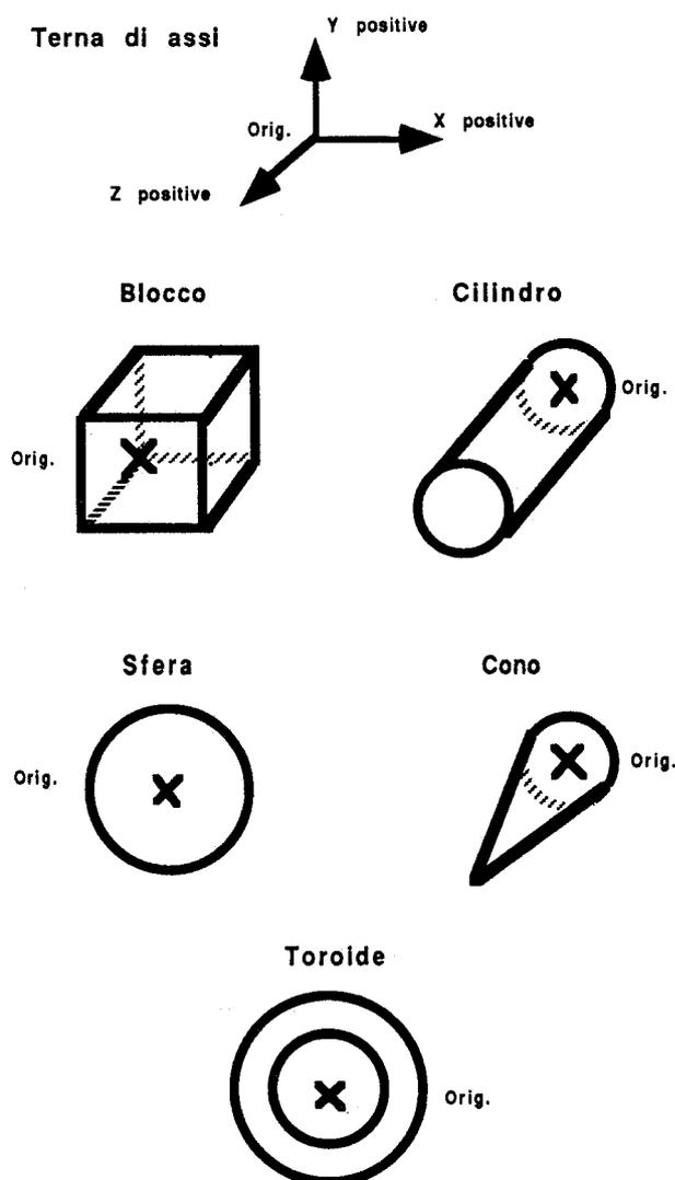
Se la terna di assi rimane il "LAB" la creazione di questi solidi viene effettuata utilizzando come punto di origine quello con coordinate  $x = 0$ ,  $y = 0$ ,  $z = 0$  del sistema di assi stesso.
