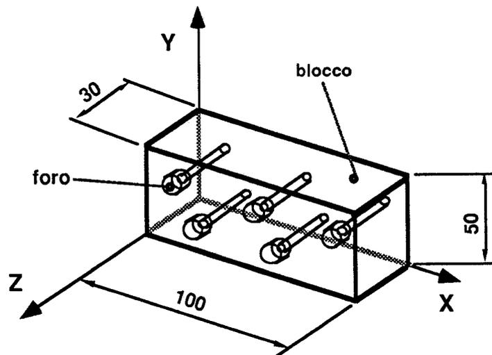
Costruire, anche sul sistema di riferimento "LAB", il solido "foro", composto da un primo cilindro (di diametro 11 mm ed altezza 19.5 mm), e da un altro cilindro (di diametro 18 mm ed altezza 10.5 mm), posizionato come in figura. Unire i due cilindri e chiamare il risultato "foro".
