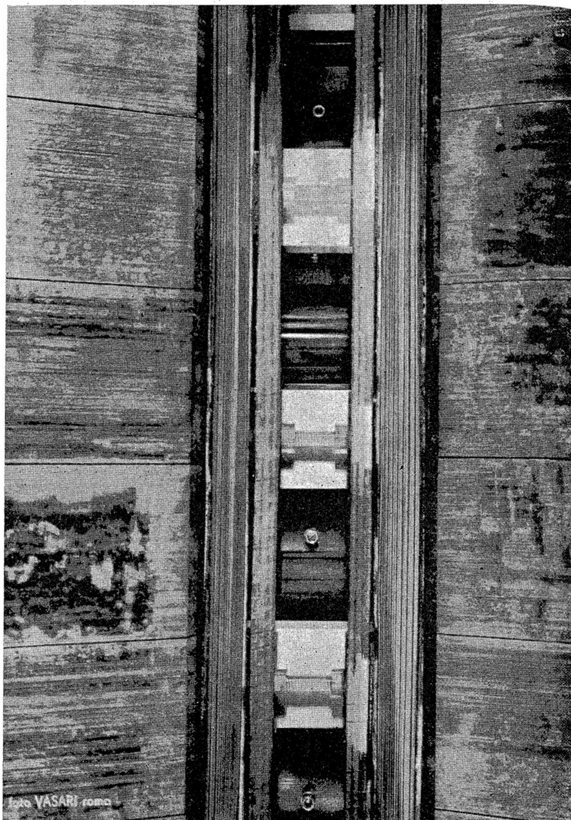
Fig. 1. — Vista delle correzioni polari che corrono parallelamente alle facce polari del magnete
