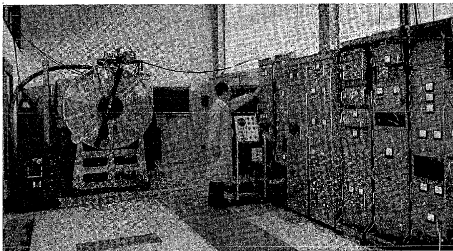
Fig. 12 - La cavità risonante a frequenza modulata montata nella sua forma definitiva, ma non ancora posta nella posizione definitiva.
