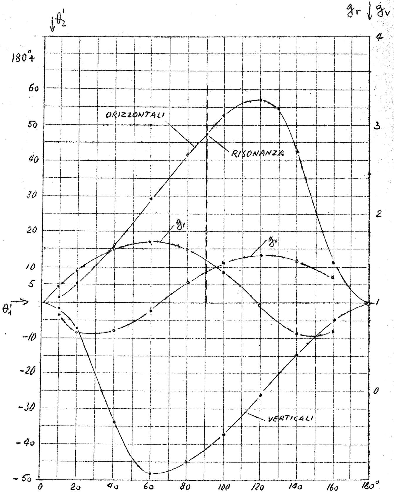
FIG. 2 - SFASAMENTI E GUADAGNI DI AMPIEZZA IN FUNZIONE DELLA FASE DI ENTRATA NEL PEELER PER OSCILLAZIONI DI BETATRONE VERTICALI E ORIZZONTALI.-
