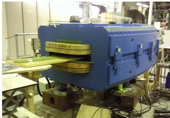
**FIG. 1** - Dipolo del sincrotrone CNAO e flussimetro per la misura del campo magnetico
