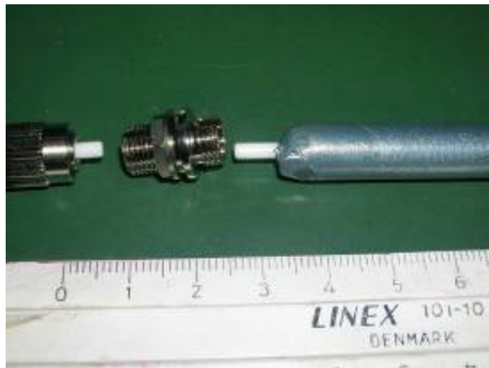
Figura 5.18 - Sistema di connettorizzazione
