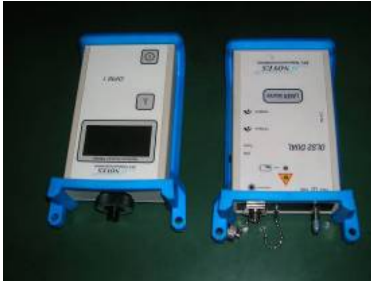
Figura 5.20 - Sistema di interrogazione: a destra il laser, a sinistra il fotodiodo (b).
