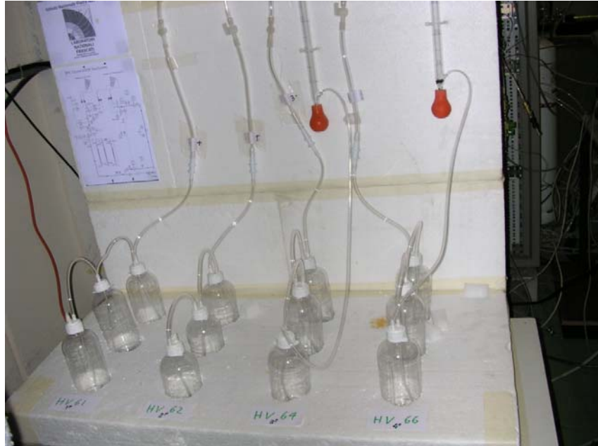
Figura 3.9 – Gorgogliatori del setup di chimica
