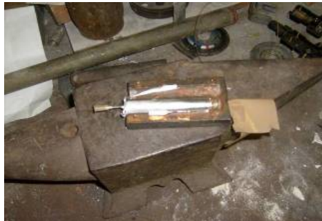
Figura 5.22 - Provino in alluminio all'interno della lingottiera
