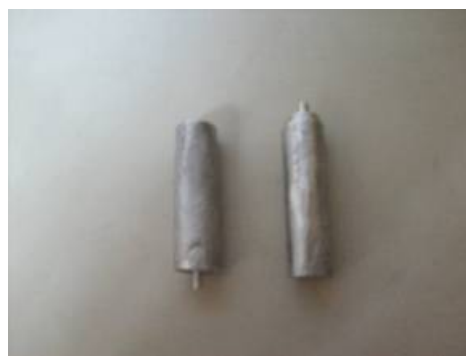
Figura 5.23 - Provini ottenuti dopo la lavorazione meccanica al tornio
