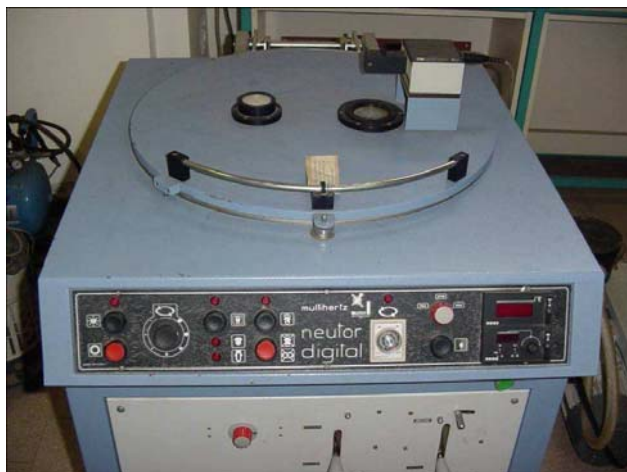
Figura 5.13 - Forno centrifugo ad induzione modello Manfredi "Neutor Digital" in dotazione nel laboratorio sperimentale del Dipartimento di Metallurgia dell'Università La Sapienza di Roma.
