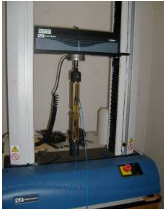
Figura 5.28 - Particolare della prova di trazione
