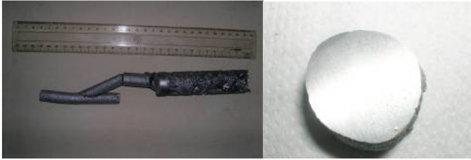
Figura 5.11 – Getto di alluminio realizzato con la tecnica del Lost Foam e sezione del getto dove si nota la discreta qualità della colata
