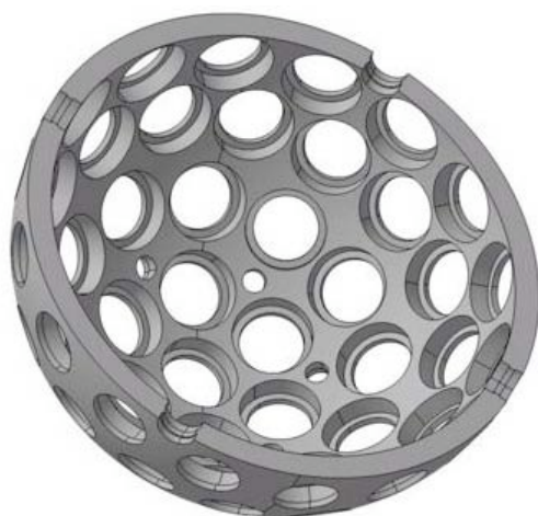
Figura 9: uno dei due semi-gusci esterni di alluminio dove sono alloggiati i CCR.
