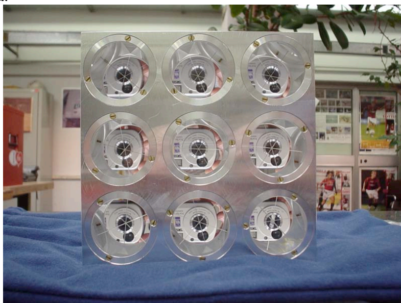
Figura 4: il prototipo dei satelliti LAGEOS, la "matrice 3x3".
