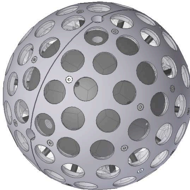
Figure 8: nel nuovo progetto del satellite i CCR sono alloggiati in un guscio esterno e pertanto si “vedono” termicamente tra loro in modo piu’ efficiente rispetto a quando erano chiusi in cavità singole, come nei LAGEOS. La sfera interna assorbe/riemette il calore da/verso tutti i CCR, favorendone l’uniformità della temperatura.
