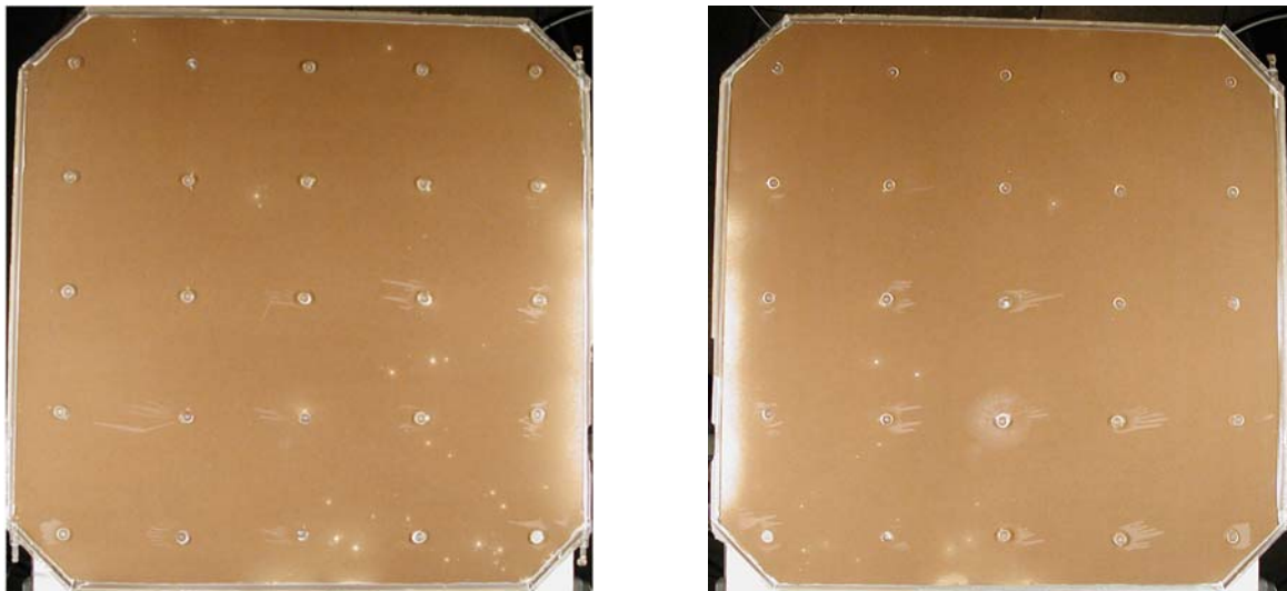
Figura 5.2 Vista interna delle lastre di bachelite (anodo a sinistra e catodo a destra), si noti la simmetria dei difetti superficiali sulle due sinonimo di un ponte elettrico tra le facce del rivelatore
