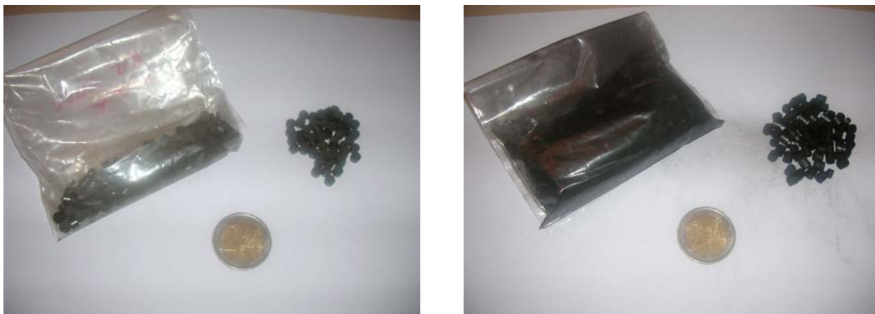
Figura 4.5 Filtro metallico CuO ZnO (a sinistra) e filtro metallico Ni-Al 2 O 3 (a destra), è evidente la presenza di grafite in tale tipologia di filtri soprattutto in quello a base allumina come si può vedere dalle polveri rilasciate
