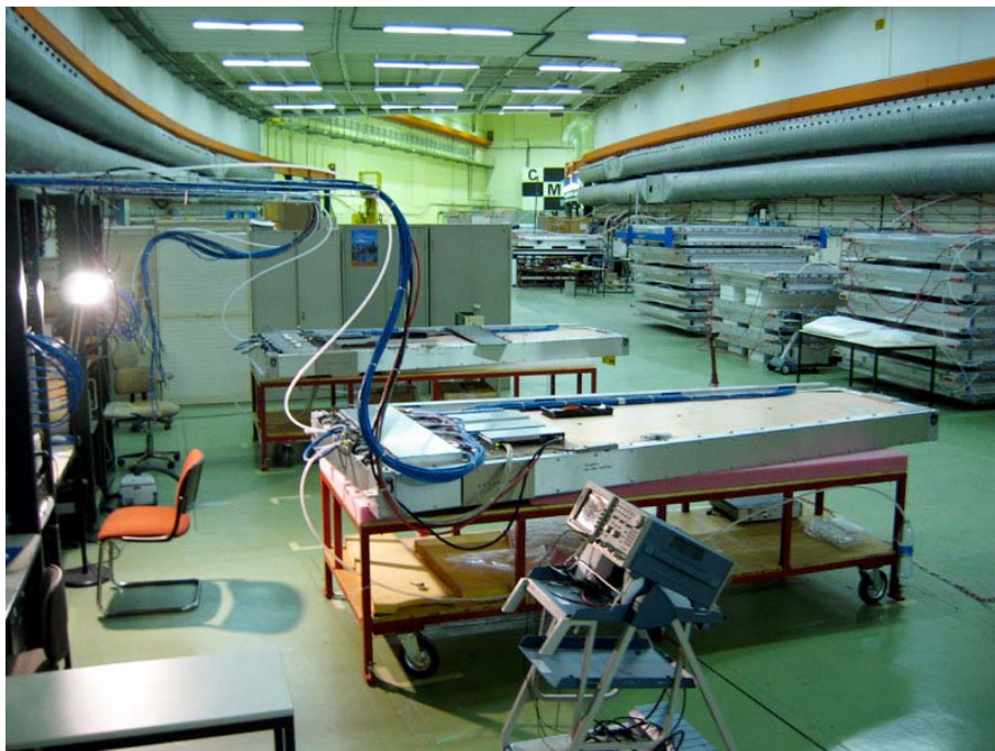
Figura 4.3 Veduta dell' area dell'ISR in cui vengono effettuati i test delle camere. In primo piano si vede una camera dell'endcap
