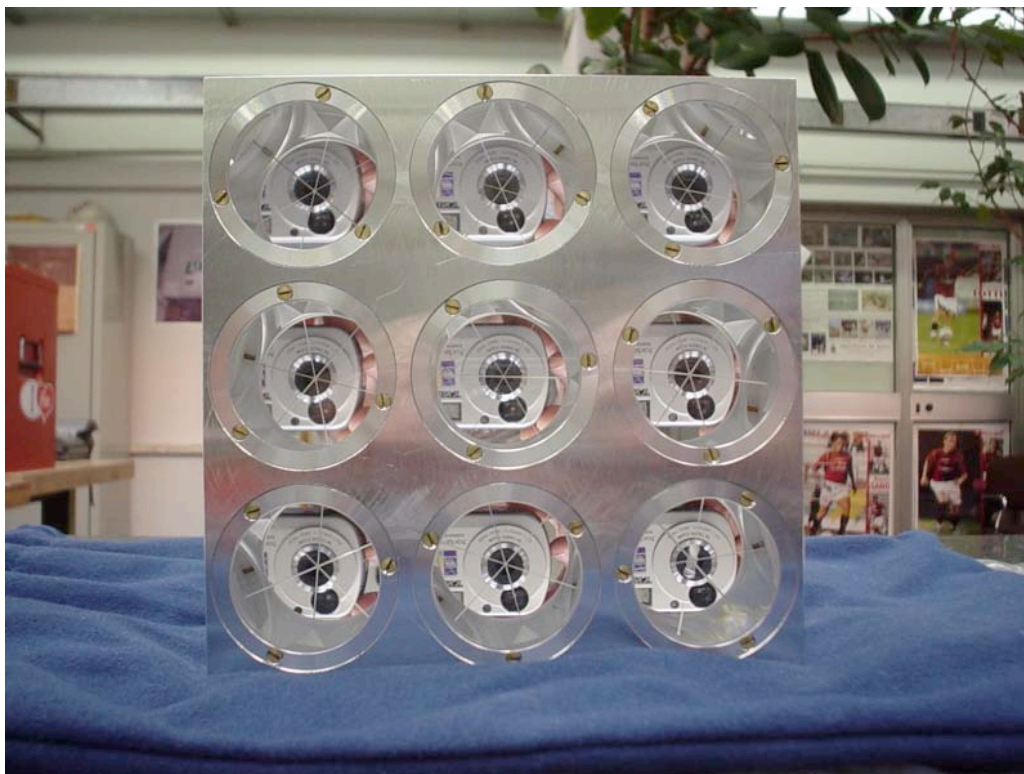
Figura 7: il prototipo dei satelliti LAGEOS costruito a Frascati, la matrice 3x3 .
