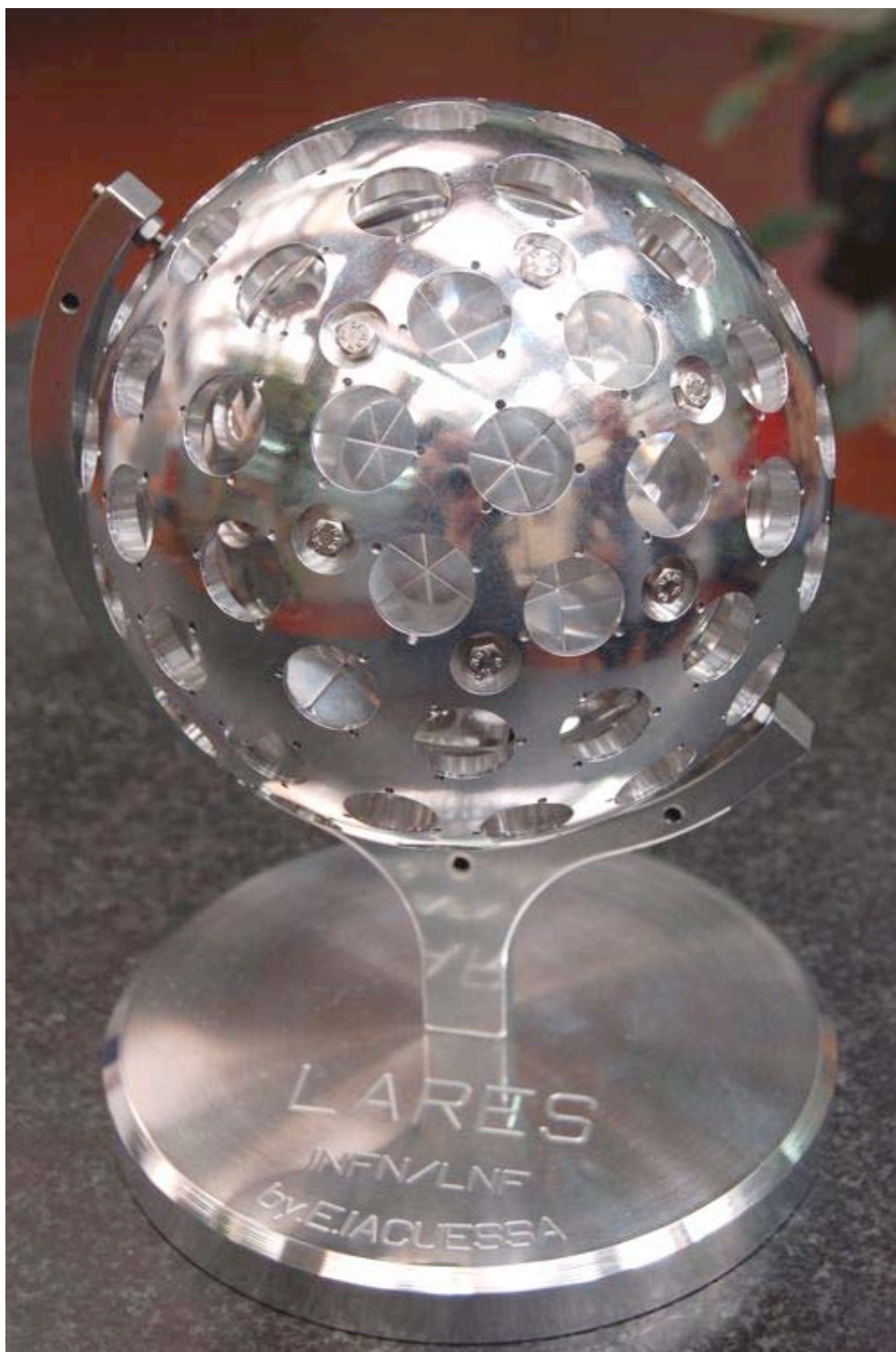
Figura 14: Prototipo del nuovo disegno di LARES (scala 1:2, diametro 16 cm).
