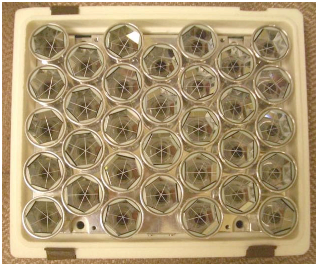
Figura 16: array di CCR della Univ. of Maryland at College Park da caratterizzare alla CSC. Questo è il terzo array costruito ed il prossimo al lancio con un satellite della costellazione GPS-2 attuale.
