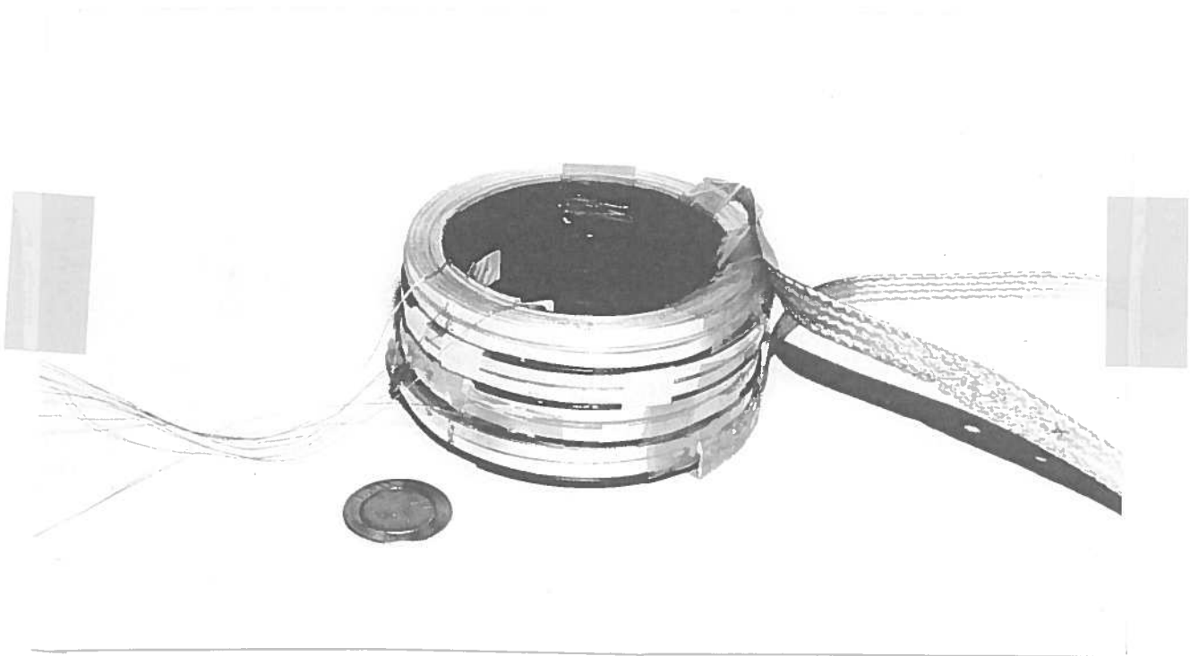
FIG. 4 - Foto del magnete assemblato (quattro doppi pancakes). Si noti la “robustezza” delle calze in rame per l’adduzione di corrente rispetto al sottile nastro da 3.5 mm x 0.28 mm di sezione.
