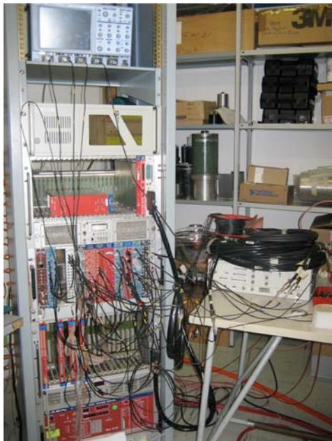
**FIG. 4:** Foto dell'hardware e della strumentazione impiegati per i test. Il generatore di impulsi, visibile nella parte destra, è collegato con l'elettronica NIM del rack; esso fornisce ai moduli VME le temporizzazioni e i segnali di Gate, oltre che alla forma d'onda per l'acquisizione, impiegata come riferimento.
