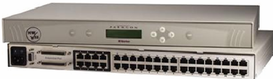
FIG. 2 Lo switch analogico Paragon, nella visione del retro si possono distinguere i 32 ingressi (cavi Cat5) per il collegamento alle catene di UKVMSPD e le 8 uscite per il collegamento alle user stations.
