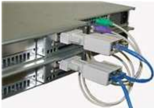
FIG. 1 Particolare del sistema daisy chain tra 2 server utilizzando il sistema Raritan ZSeries UKVMSPD e cavi di categoria Cat5.
