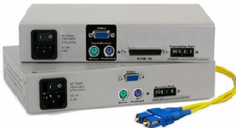
FIG. 5: L'apparato Raritan Fibre Reach II composto dalle 2 parti trasmettitore e ricevitore connesse tra loro da fibra ottica (multimodale o monomodale) con connettore SC
