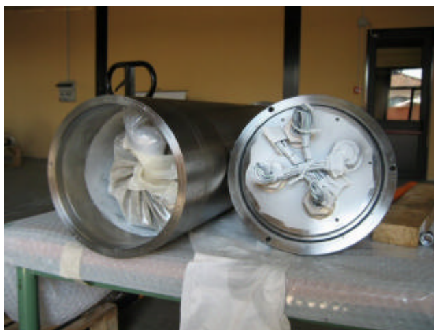
Fig.6: Ispezione cilindri dopo il test in pressione.
