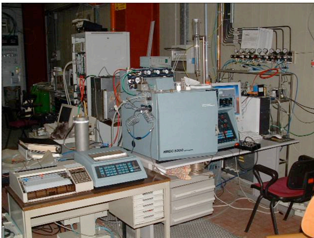
Figura 1: il setup del gas-cromatografo con tutte le apparecchiature annesse
