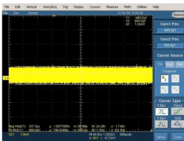
Fig. 1 - Noise del TEK mod. su infinita persistenza con ingresso chiuso a massa
