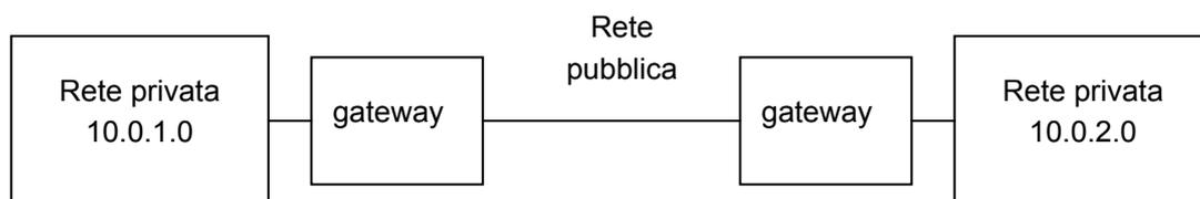
La nostra situazione è un caso particolare e semplificato dello schema precedente, in quanto si richiede di attivare il tunnel solo fra due nodi.
