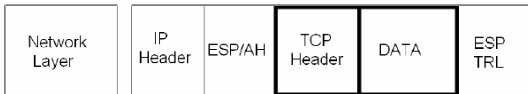
Fig. 2. IPsec in modalità Tunnel.
