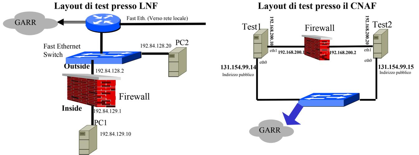
Queste reti di test ci hanno permesso di realizzare tutte le configurazioni di prova senza impattare sul traffico di produzione.
