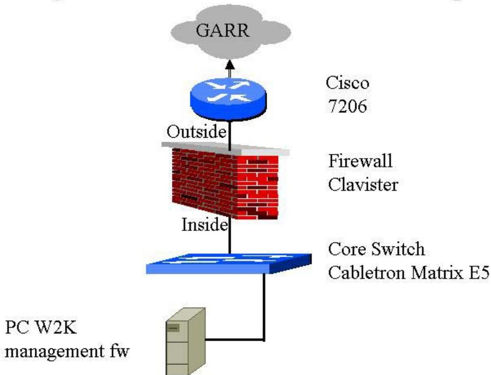
Sono state configurate sul FW le stesse ACL presenti sul Router Cisco (circa 300 righe) per poterne verificare le prestazioni in condizioni di traffico normale (traffico medio della sezione nel periodo è di circa 10-15 Mb/s e l'occupazione di cpu del Router Cisco non va mai oltre il 10%).
