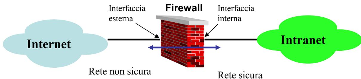
Per discriminare quale pacchetto può transitare attraverso al Firewall vengono definite delle *Access Control List* (ACL) costituite da un insieme di regole che vengono applicate alle interfacce del Firewall in ingresso o in uscita.
