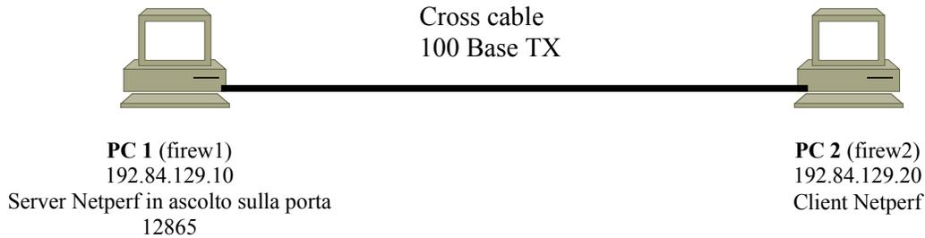
Tutti i test di throughput sono stati effettuati utilizzando Netperf reiterando i test e variando i parametri di netperf (Durata dei test, dimensione del messaggio ..).
