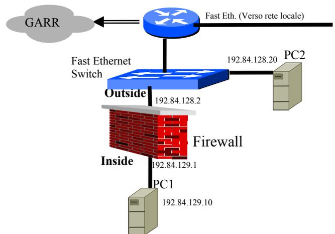
Non si notano particolari differenze nel throughput passante all'aumentare delle linee di ACL applicate.
