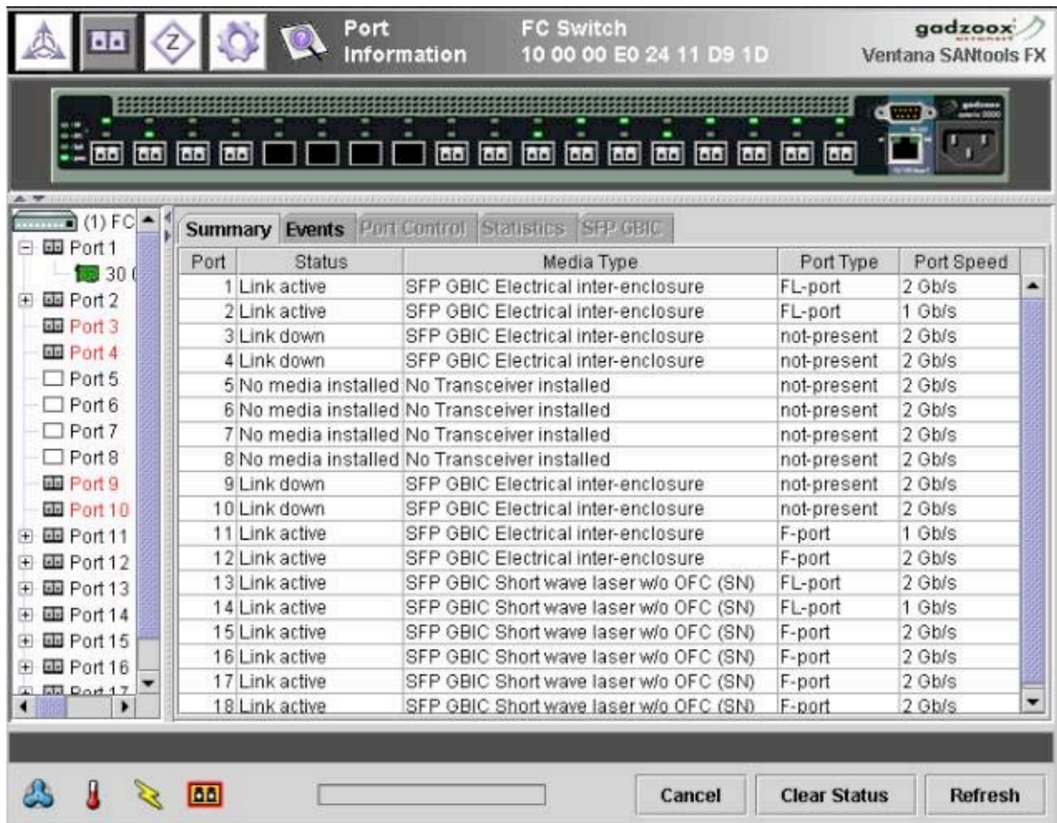
Fig. 7 Uno screenshot della applicazione Java Ventana SANtools accessibile via browser sullo switch Fibre Channel Gadzoox 4218. In particolare in questa finestra si possono vedere gli stati delle 18 porte dello switch.
