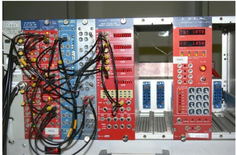
Illustration 3: Elettronica per l'elaborazione dei segnali. Da sinistra: un discriminatore; due unità logiche; un fan-in/fan-out; un contatore; un alimentatore HV.
