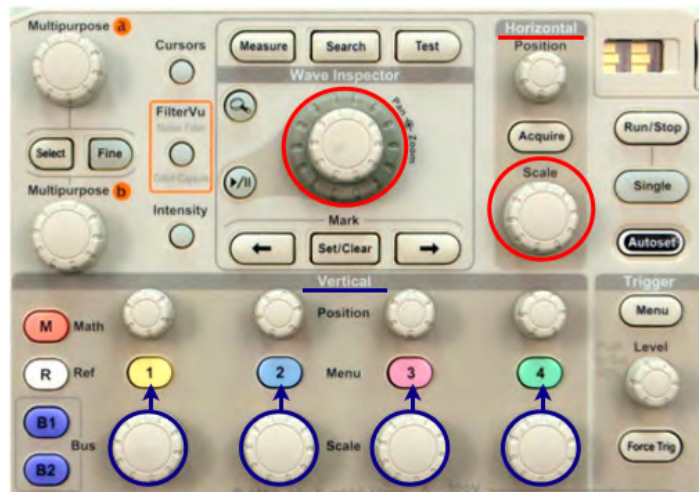
Figura 4: Manopole necessarie per modificare la scala orizzontale (evidenziate in rosso) e verticale (evidenziate in blu) sullo schermo dell'oscilloscopio.
