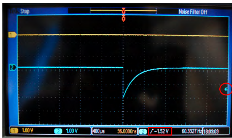
Figura 5: Freccia che indica sullo schermo il livello di trigger (evidenziata in rosso) e valore numerico corrispondente (sempre evidenziato in rosso).
