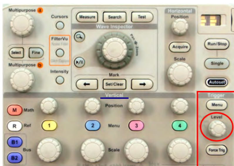
Figura 6: Manopola con la quale è possibile modificare il livello di trigger (evidenziata in rosso).
