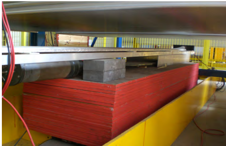
Figura 1: Foto del rivelatore. Sono visibili i due scintillatori sovrapposti e uno dei due fototubi. Il tutto è appoggiato sopra delle lastre di ferro.
