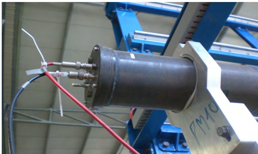
Figura 10: Retro di un fotomoltiplicatore. Il cavo rosso porta l'alta tensione (2 kV) mentre quello nero porta il segnale in uscita.
