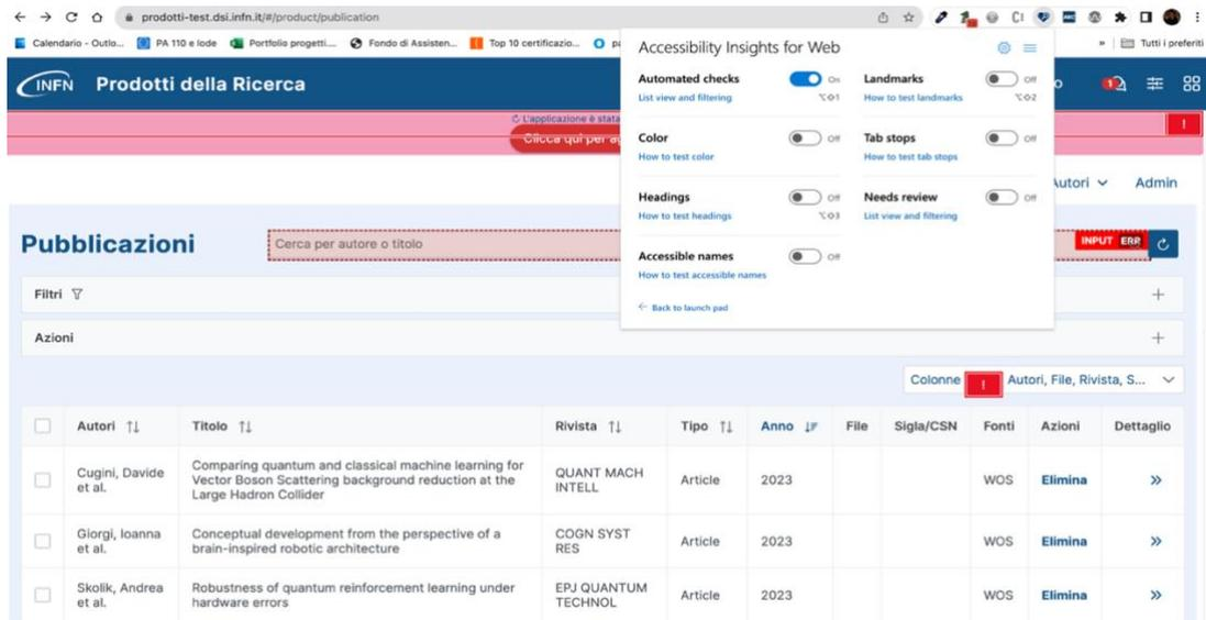
**Accessibility Insights for Web** segnala direttamente nella pagina in modo preciso gli elementi errati, fornisce un modo per individuarli agevolmente nel codice e ne suggerisce la risoluzione. Inoltre, mette a disposizione altri strumenti per l'analisi della struttura della pagina e guida l'auditor del sito nel costruire report di accessibilità.
