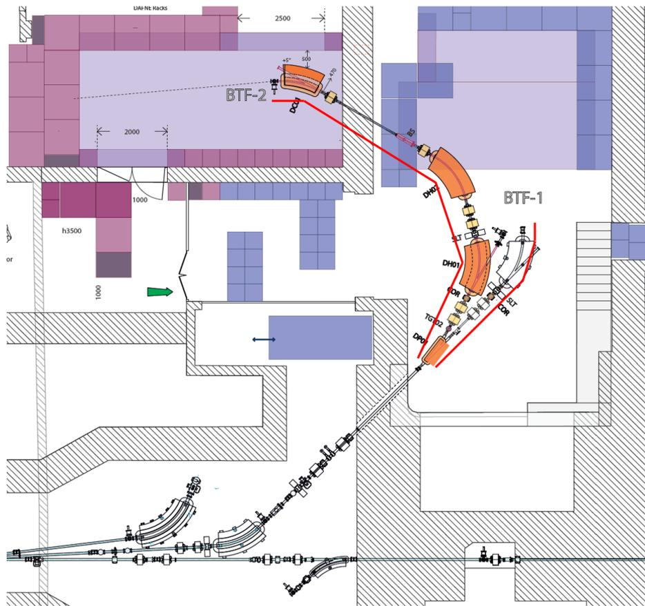
Figure 2: In rosso i segmenti di fibre scintillanti da installare lungo le due linee di fascio.
