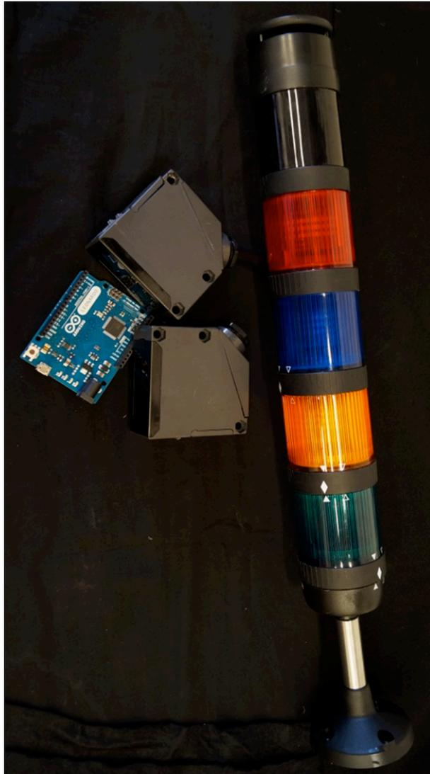
**Figura 3:** Foto del microcontrollore Arduino a sinistra, dei sensori di occupazione al centro e dei segnalatori luminosi e sonoro a destra.
