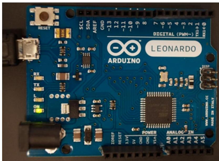
**Figura 2:** Fotografia del micro-controllore Arduino Leonardo utilizzato per il controllo delle periferiche.
