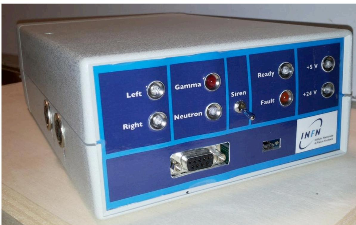
**Figura 5:** Foto della *Peripheral devices box*, la scatola contenente l'apparato di gestione delle periferiche controllato da Arduino.
