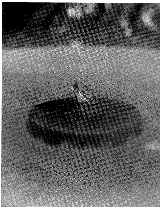
FIG. 47 - Effetto Meissner su una nostra pasticca sinterizzata di YBCO fatta con il metodo della pirolisi ed ozono. Il piccolo magnete ha un'intensità di campo di 2000 Gauss e la temperatura della pasticca è di circa 85 K.
