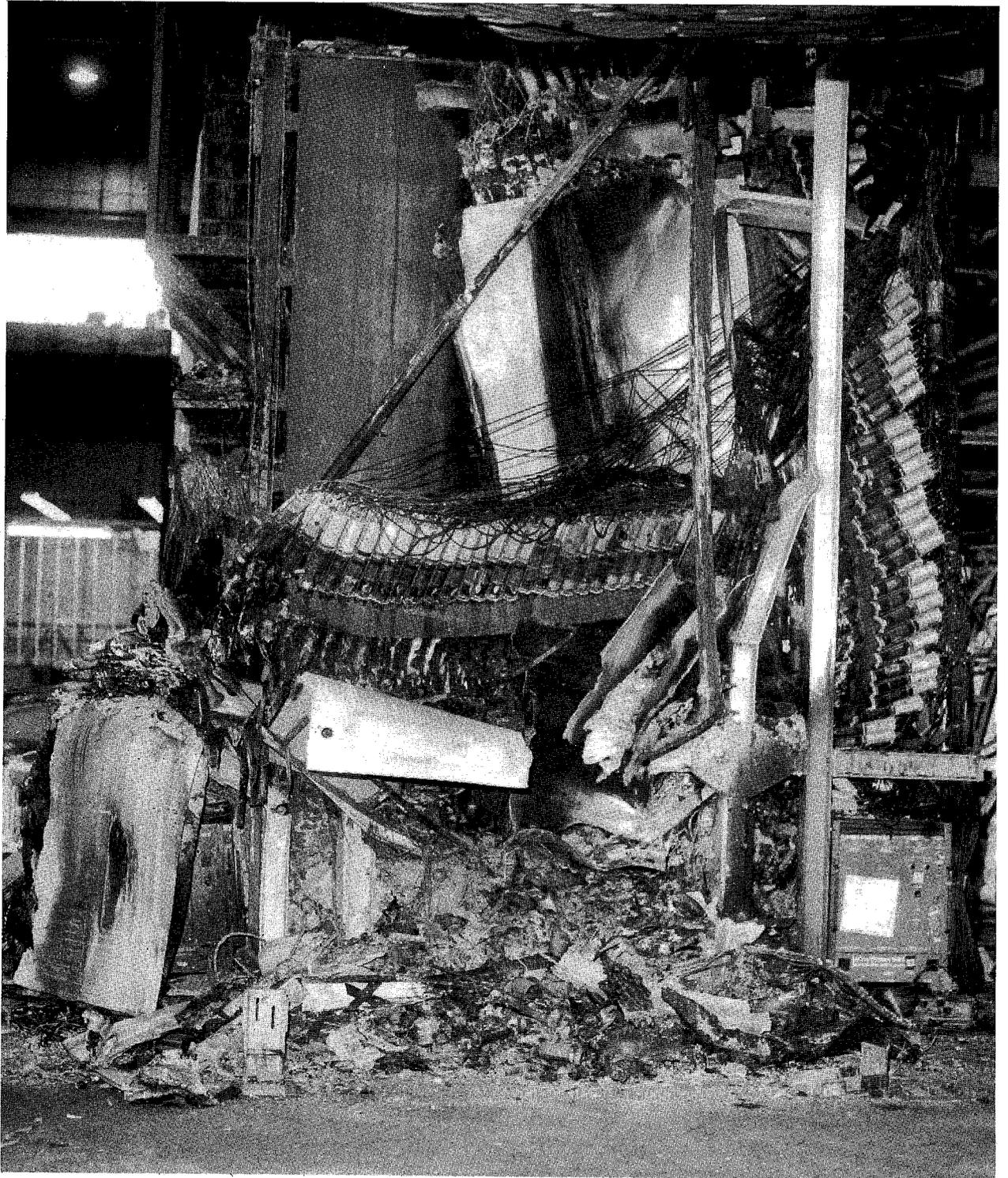
*Fig. 9 - Il calorimetro elettromagnetico esterno dopo l'incendio*
