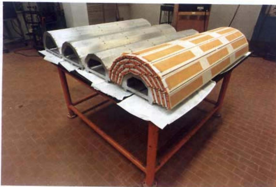
FIG. 89 - Esp. FENICE — Stampi per l'assiaggio del rivelatore di vertice.
