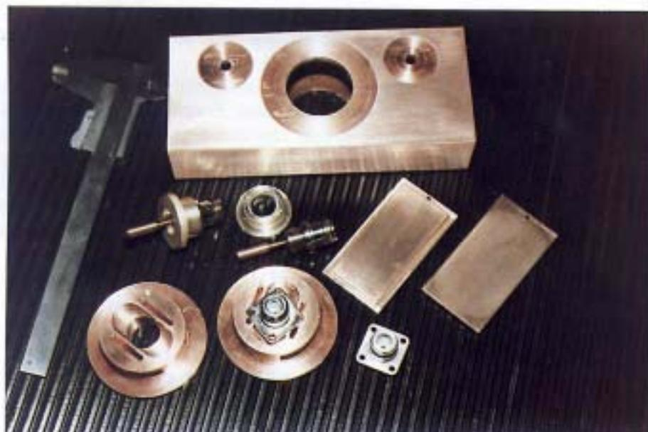
FIG. 79 - Componenti monitors-intensità fascio Linac.
