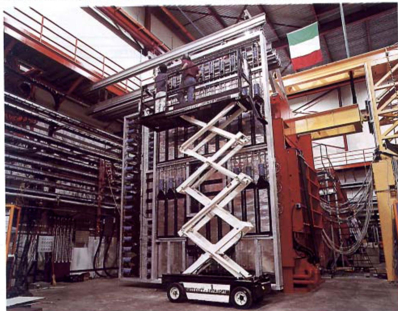
FIG. 7 - Montaggio del calorimetro esterno nella hall del FermiLab.
