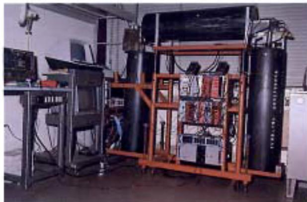
FIG. 69 - Rivelatore di neutroni a 3 contatori proporzionali ad <sup>3</sup>He.
