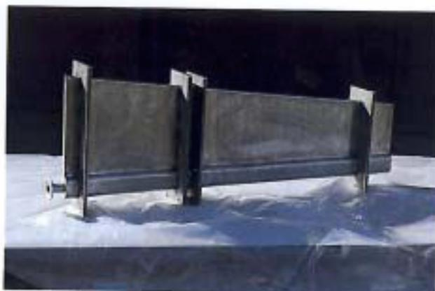
FIG. 85 - Prototipo della camera da vuoto di Afrodite.
