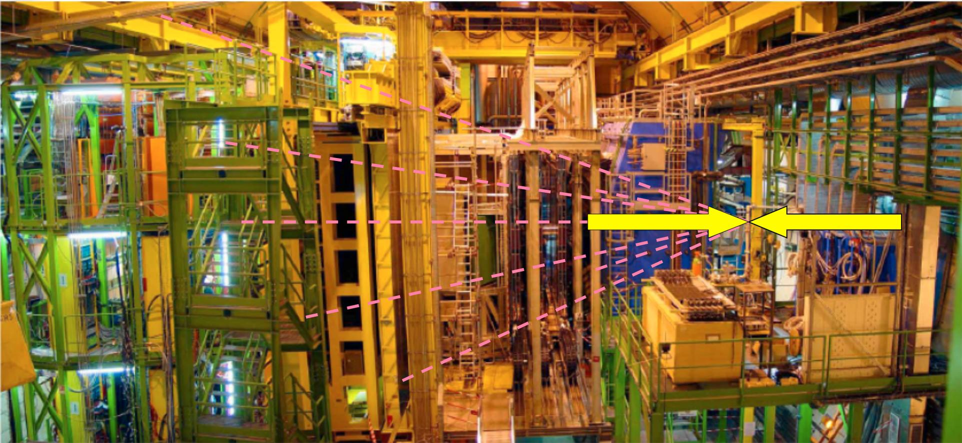
E' un apparato che ha la caratteristica di rivelare solo le particelle che vanno in avanti rispetto ad una direzione dei protoni, al contrario degli altri che accettano particelle in tutte le direzioni
