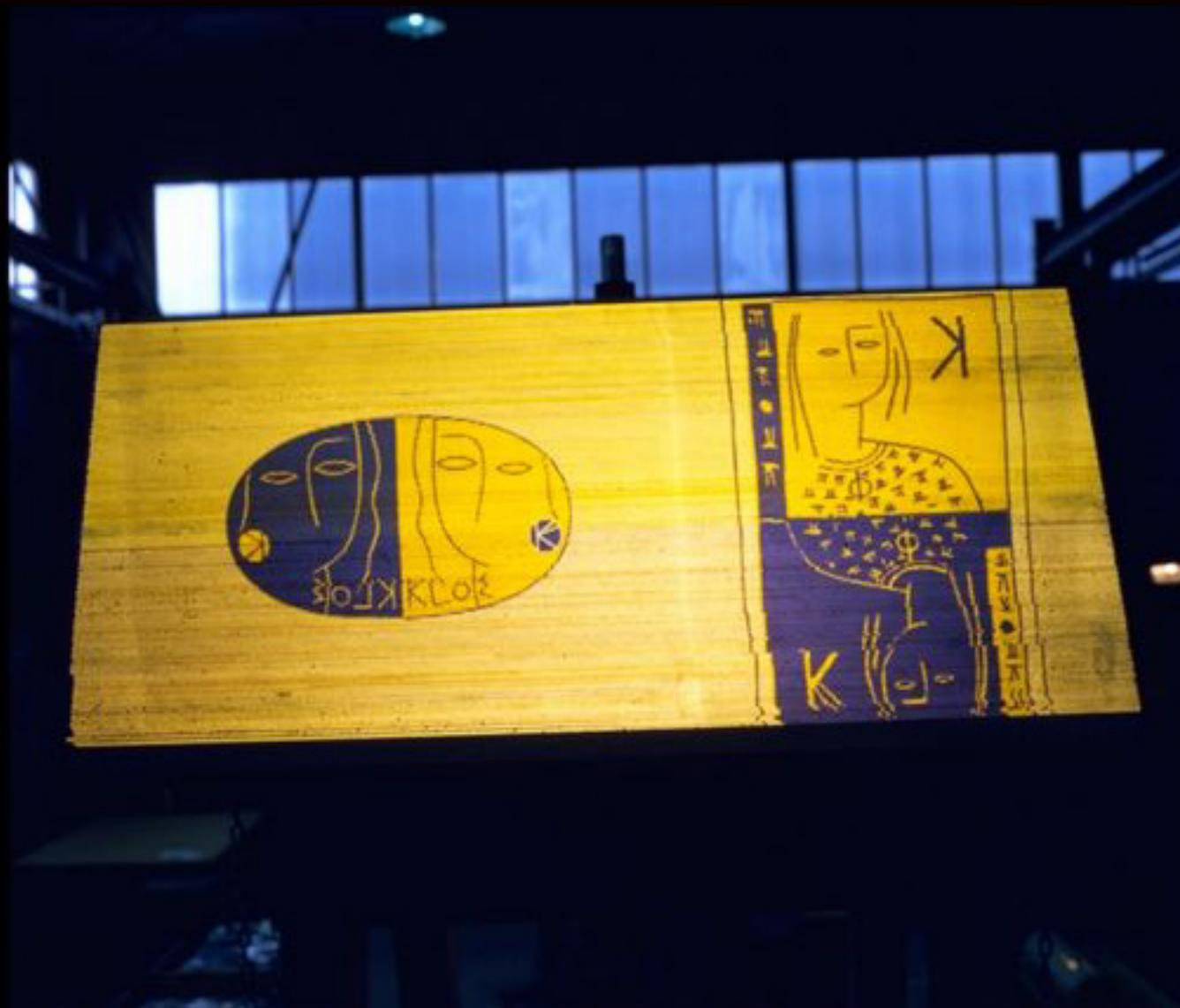
La luce viene trasmessa per l'intera lunghezza del modulo, 4 m, evidenziando la trasparenza del sandwich di piombo e fibre scintillanti di cui è costituito il calorimetro elettromagnetico di KLOE. Le immagini visibili, poste sul retro davanti alla lampada, sono rappresentative della simmetria CP studiata attraverso i decadimenti dei Kaoni.
