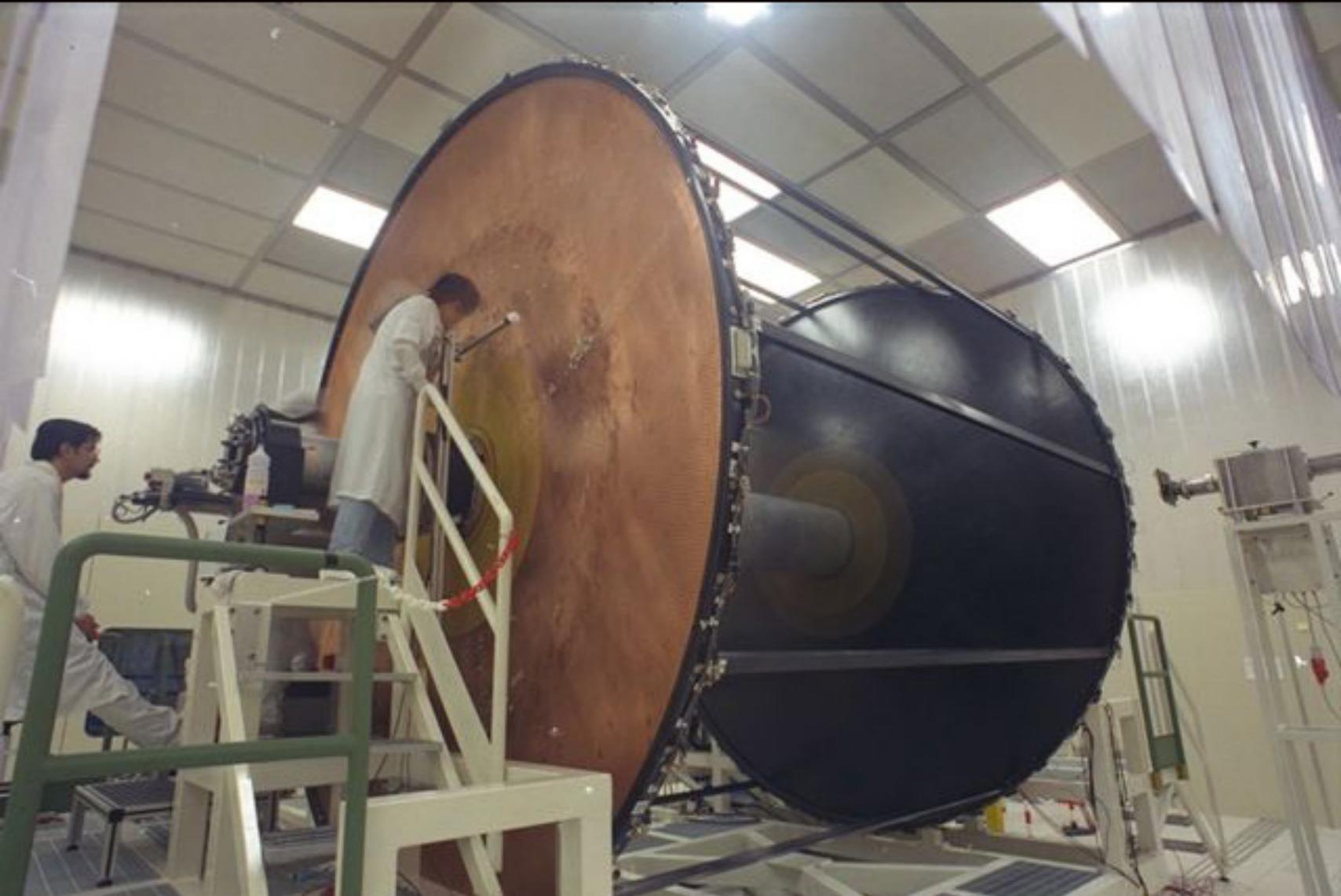
Per la tessitura semi-automatica dei fili si è utilizzato un braccio robotizzato in grado di stendere i fili sottilissimi, in alluminio e tungsteno, lungo i 4 m che separano i piatti della camera. I fili sono stati poi fissati manualmente, tramite pin precisamente localizzati, sul piatto in primo piano nella fotografia. La procedura è stata tenuta sotto controllo dalla telecamera collegata ad un computer, visibile sulla destra.
