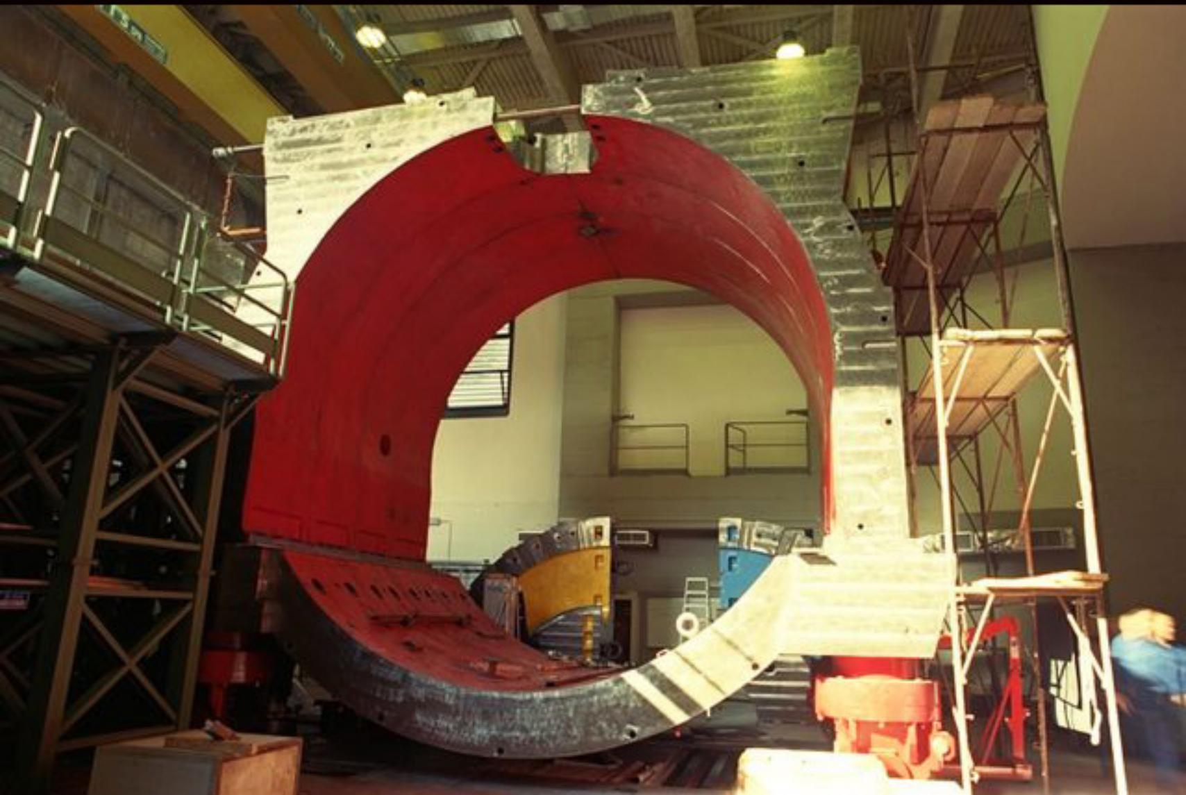
Struttura in ferro pronta per l'installazione al suo interno del magnete cilindrico superconduttore in grado di generare il campo solenoidale di circa 6 kGauss necessario alla misura dell'impulso delle particelle cariche.
