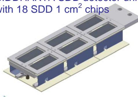
**Figura 7: 6 unità di 3 rivelatori SDD, ognuno con una superficie attiva di 1 cm<sup>2</sup>, letti indipendentemente – sistema reale**
