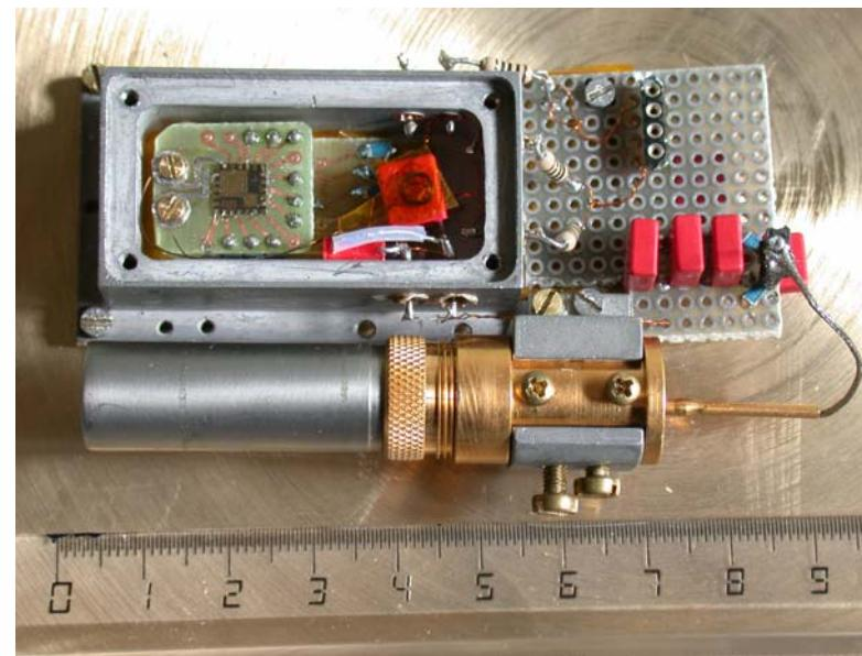
High-Q input circuit ( $L_0=96\text{mH}$ ,  $Q_0=0.7 \cdot 10^6$ ,  $k=0.38$ ).
