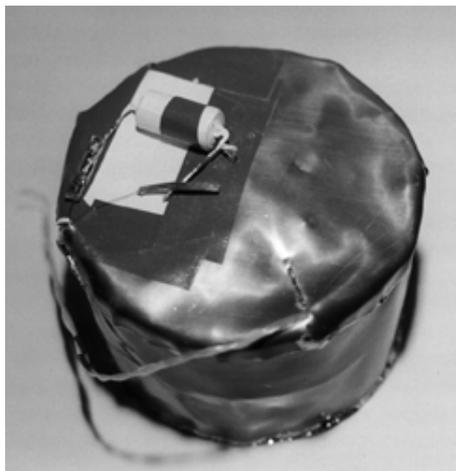
Figura 4.4: Il trasformatore pronto per la misura di  $Q$ .
