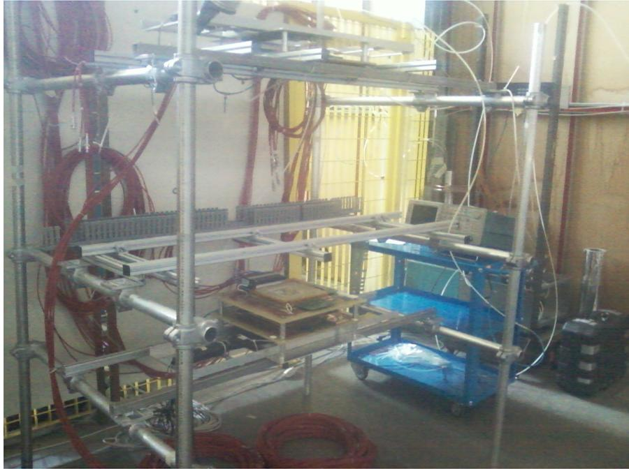
Fig. 1: Telescopio composto da 3 camerette a GEM e lettura digitale. La cameretta planare di test andrà inserita nello spazio vuoto tra le 2 camerette inferiori e quella superiore.
