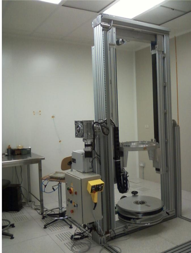
Fig. 3: La “clessidra” reversibile per l’inserzione degli elettrodi cilindrici uno nell’altro
