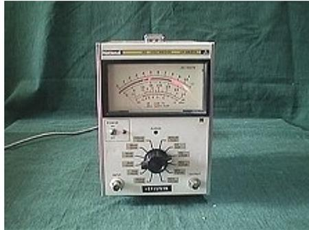
Il voltmetro è uno strumento che misura la differenza di potenziale (d.d.p.) tra due punti di un componente di un circuito attraversato da corrente elettrica.
