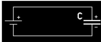
Il condensatore è caratterizzato da una **capacità (C)**, che si misura in **farad (F)**. La quantità di carica **Q** misurata in *coulomb* e immagazzinata da un condensatore è uguale a:
