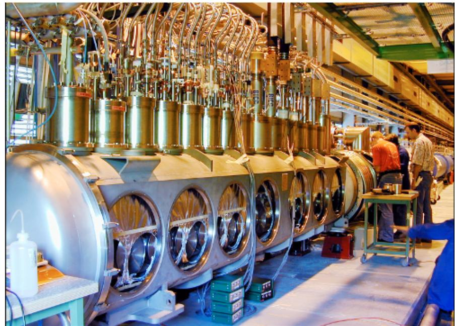
Per permettere di mantenere i fasci di protoni in circolo, vengono usati 1600 magneti superconduttori che producono campi magnetici 80000 volte piu intensi di quello terrestre.
