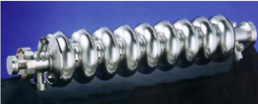
cavità a radiofrequenza di ILC (International Linear Collider)
