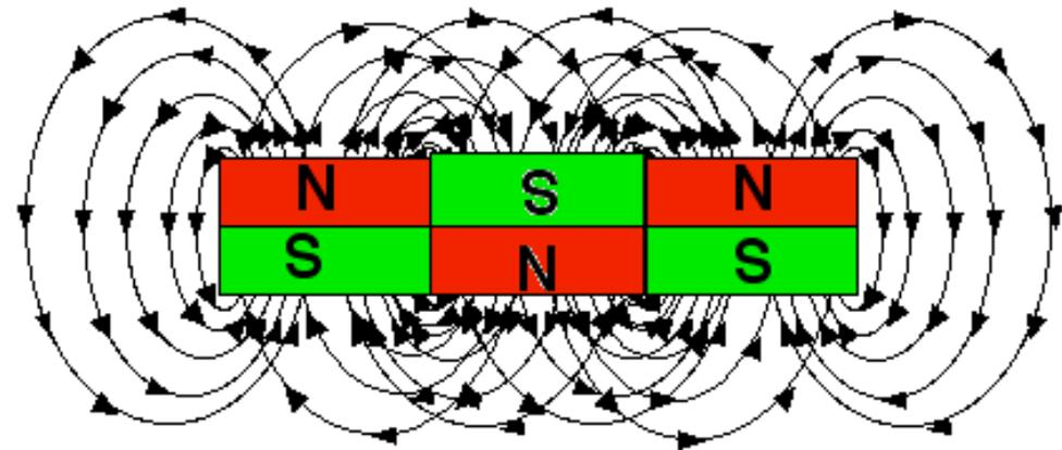
treno con materiale superconduttore in stato normale su rotaia magnetica  $T(K) > T_c$
