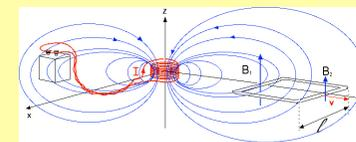
La risposta magnetica verra' misurata da un **ponte bilanciato di bobine** avvolte in modo anti induttivo (tensione ai capi del ponte= 0Volt).
