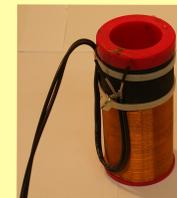
Il **campione** viene posto su una barretta di zaffiro e inserita in **una** delle due bobine del ponte. Qualsiasi effetto magnetico sbilancia il ponte di bobine (tensione ai capi del ponte  $\neq 0\text{Volt}$ ) .
