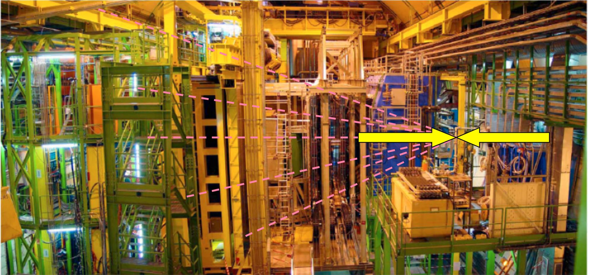
E' un apparato che ha la caratteristica di rivelare solo le particelle che vanno in avanti rispetto ad una direzione dei protoni, al contrario degli altri che accettano particelle in tutte le direzioni
