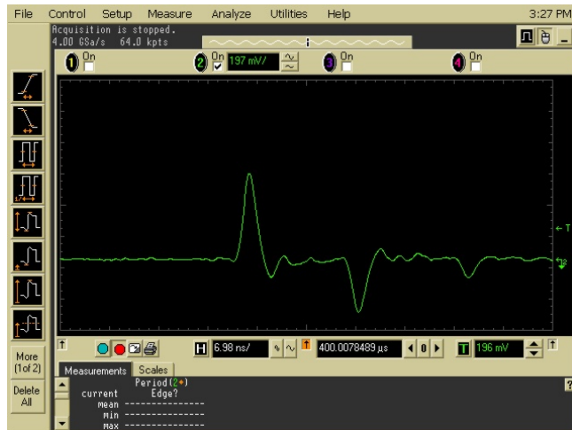
Riflessione di un impulso applicato al cavo terminato in corto circuito
