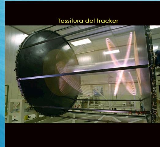
Kloe è un rivelatore che ha il compito di rivelare le particelle attraverso una camera a deriva che ne ricostruisce le traiettorie e un calorimetro che ne misura l'energia
