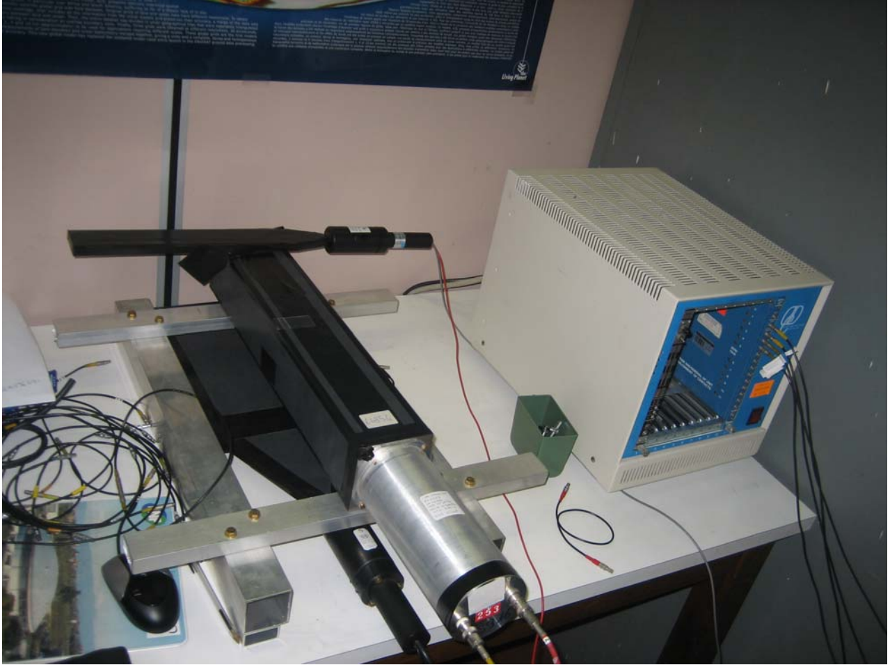
Figura 6. Esempio di differente posizionamento dello scintillatore piccolo
