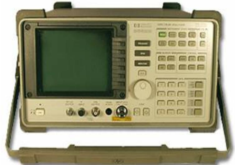
HP 8562B - Analizzatore di spettro
