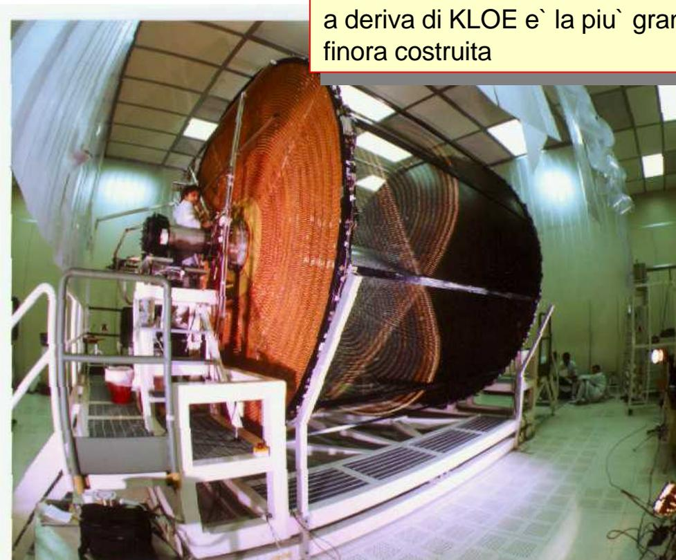
Gli straw tubes sono camere a deriva cilindriche "moncanale". Per ottenere informazioni sulle diverse coordinate spaziali si possono usare piani incrociati di tubi.
