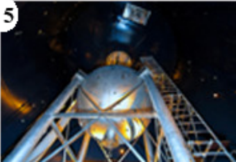
5 Mario Rinaldi Laboratori Nazionali del Gran Sasso - INFN Sfera interna dell'esperimento DARKSIDE
