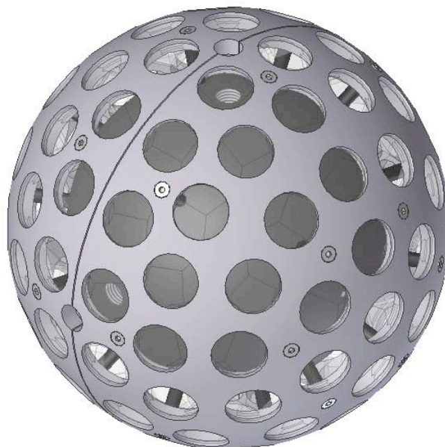
Figure 8: nel nuovo progetto del satellite i CCR sono alloggiati in un guscio esterno e pertanto si “vedono” termicamente tra loro in modo piu' efficiente rispetto a quando erano chiusi in cavità singole,
