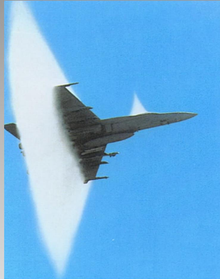
L'angolo del cono dipende dalla velocità dell'aereo e dalle proprietà di rifrazione del mezzo.
